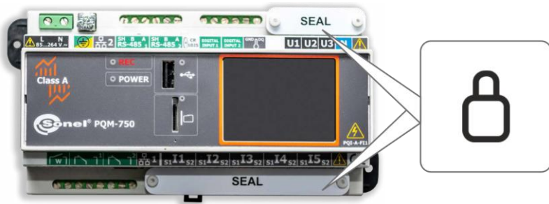
Fig. 6. Sellado de entradas de medición.
